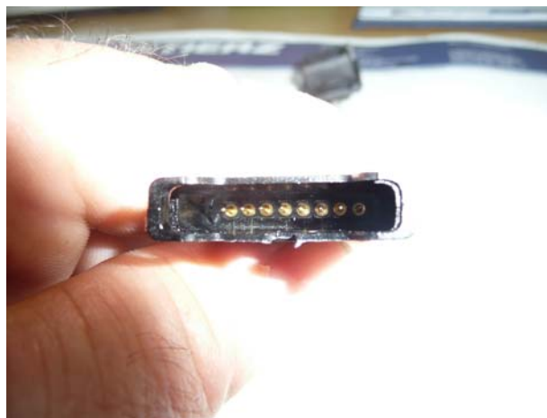
10: Prüfmuster 8-polig nach Wasserprüfung.
