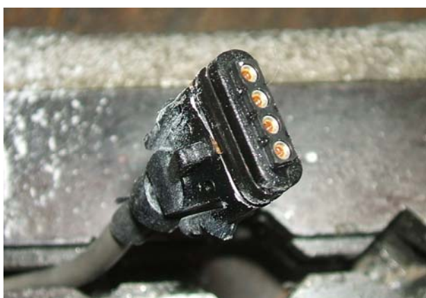
3: Prüfmuster 4-polig nach der Staubprüfung.
