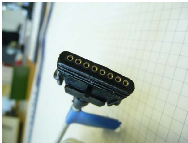
6: Prüfmuster 8-polig nach Wasserprüfung.
