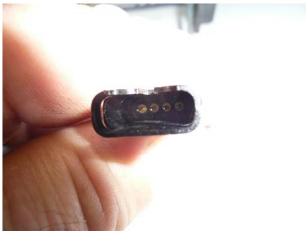
9: Prüfmuster 4-polig nach Wasserprüfung.
