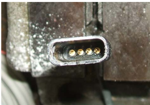
7: Prüfmuster 4-polig nach Staubprüfung.
