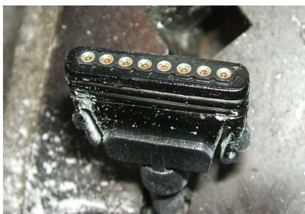
4: Prüfmuster 8-polig nach der Staubprüfung.
