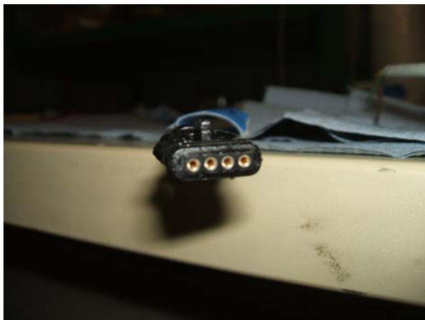
5: Prüfmuster 4-polig nach Wasserprüfung.
