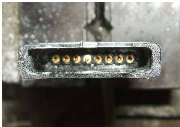
8: Prüfmuster 8-polig nach der Staubprüfung.
