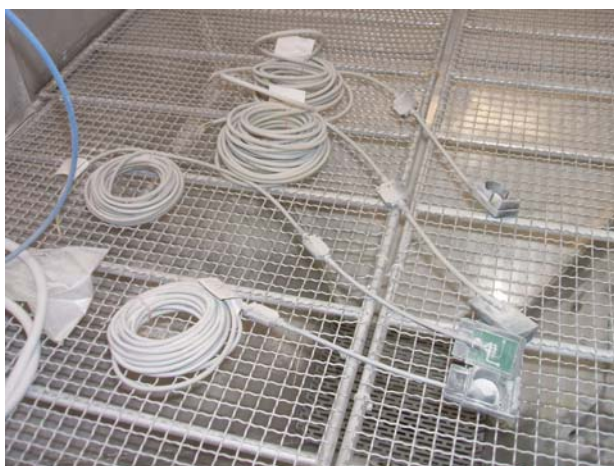
1: Prüfmuster in der Staubkammer.
