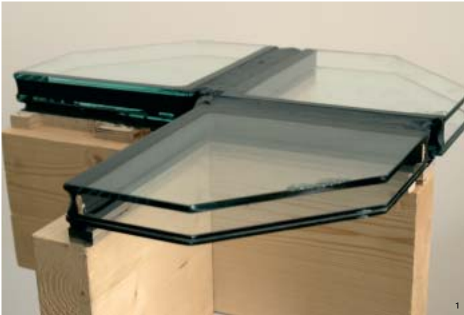
1 und 2 Konstruktionsprinzip des Holz-Glas-Verbundelementes und erste Versuche damit als Fassadensystem am Bauteilprüfstand
