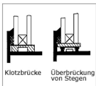
Bestehen seitens des Rahmenherstellers systembezogene Klotzungsvorschriften, so müssen diese mit uns abgestimmt werden. Dies gilt z.B. für die Klotzung von Isolierglaseinheiten in schwach dimensionierten Rahmenprofilen, um ein Durchbiegen des Flügelrahmens zu vermeiden. Der kleinste zulässige Abstand von der Glasecke beträgt 20 mm, da sonst Glasbruchgefahr besteht.
