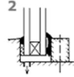
2 *Geschlossenporiges Vorlegeband mit elastischer Versiegelung witterungsseitig und raumseitig in ein Dichtprofil eingerollt oder eingeschoben.*
