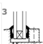
3 *Proilverglasung mit eingerollten oder eingeschobenen Dichtprofilen, die den Anpressdruck nur aus dem Profil-Eigendruck beziehen.*
