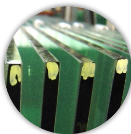
Markierung nach Heat-Soak-Test
